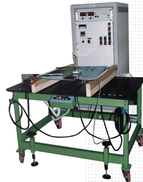
BANCO PER CONTROLLO filamenti elettrici lunotti termici completo di Realizzazione elettrica e meccanica
